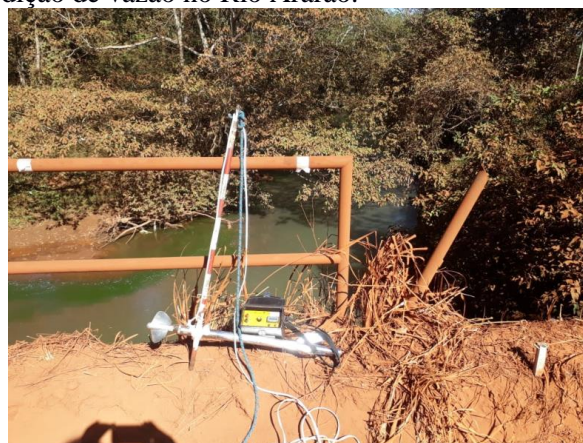
Figura 261. Equipamento para medição de vazão no Rio Ararão.
