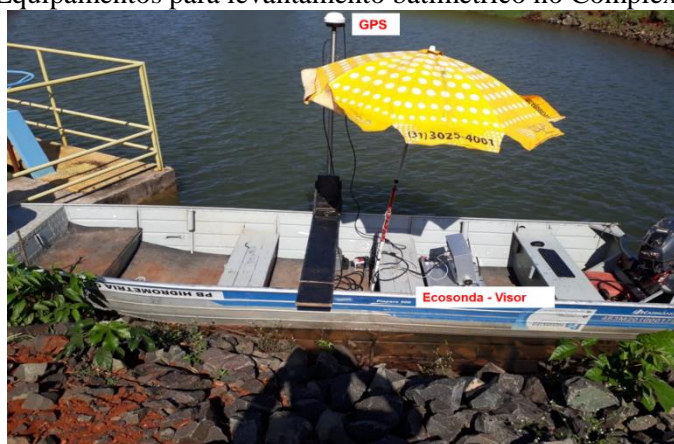
Figura 123. Equipamentos para levantamento batimétrico no Complexo de Represas
