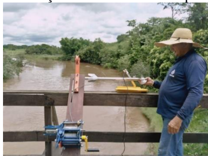
Figura 145. Equipamentos utilizados para determinação de vazão no Rio Sepotuba
