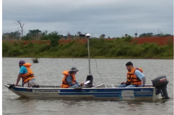
Figura 124. Levantamento batimétrico no Complexo de Represas do SAMAE.
