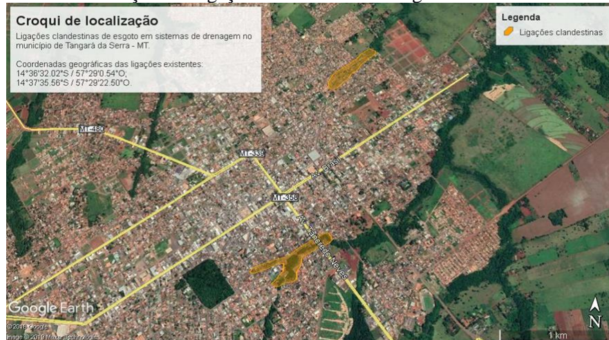
Figura 396. Localização das ligações clandestinas de esgoto em sistemas de drenagem
