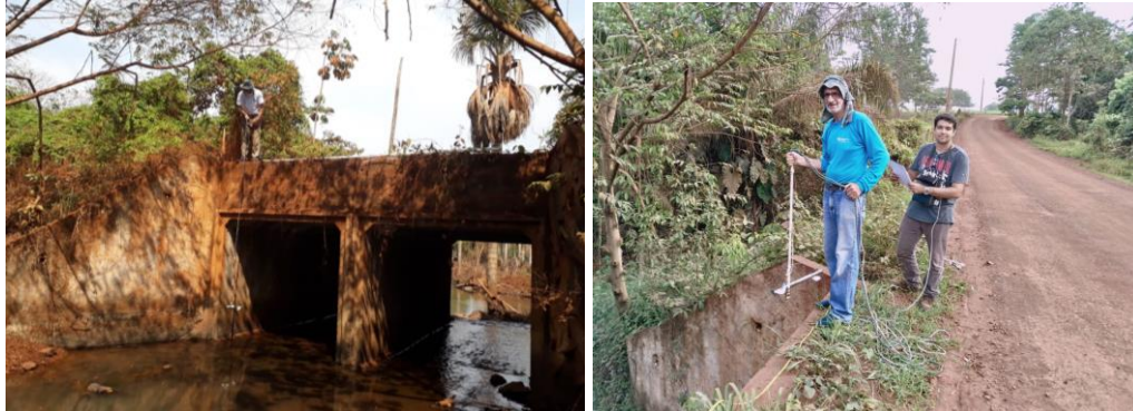
Figura 133. Determinação de vazão no Córrego Queima-Pé a montante ETA.
