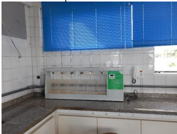
Figura 184. Jar test utilizado para ensaios de mistura na ETA Queima-Pé.
