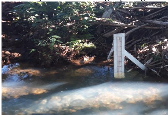
Figura 325. Medição dos níveis de água por régua linimétrica.
