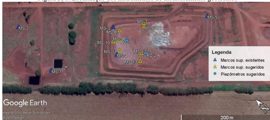
Figura 330. Localização dos instrumentos de monitoramento geotécnico
