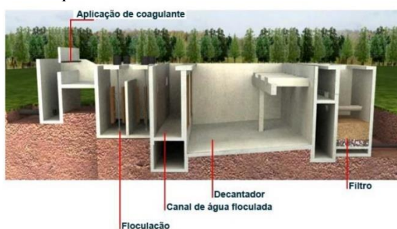
Figura 181. Esquema de uma ETA com tratamento convencional.
