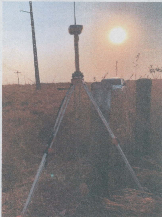
(Imagem 3): Aparelho GNSS, estacionado no VÉRTICE M-03, dando início as marcações;
