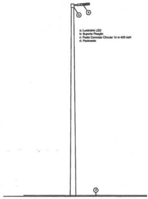
Montagem Típica dos Postes com 01 Luminária
